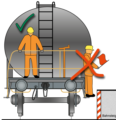
Abbildung 11c: rot/weiß gekennzeichnete Gefahrenstellen
