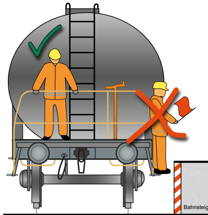
Abbildung 10c: Rot/weiß gekennzeichnete Gefahrenstellen
