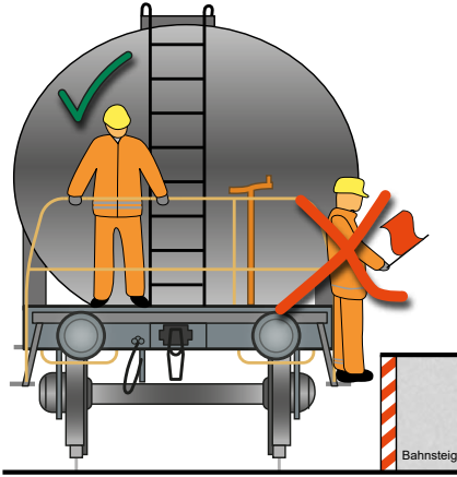
Abbildung 10c: Rot/weiß gekennzeichnete Gefahrenstellen
