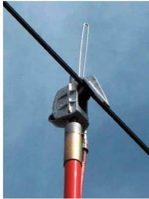
Abbildung 14f: Einhängen der Fahrdrahterdungsklemme
