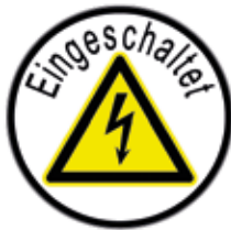
Abbildung 11a und 11b: Schaltzeiger „Oberleitung des Ladegleises ist eingeschaltet“
